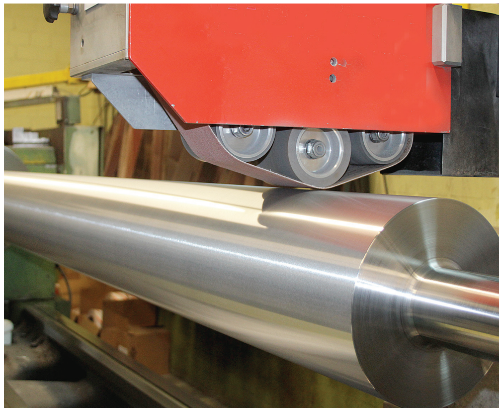
Bolz Production slijpt en polijst haar walsen met een diameter van 1.240 mm en een lengte tot 6.000 mm tot een ruwheid van Rmax 0,5 en Rz 0,3.
